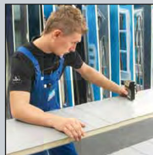
Ici nous vérifions l'épaisseur du laquage du panneau.
