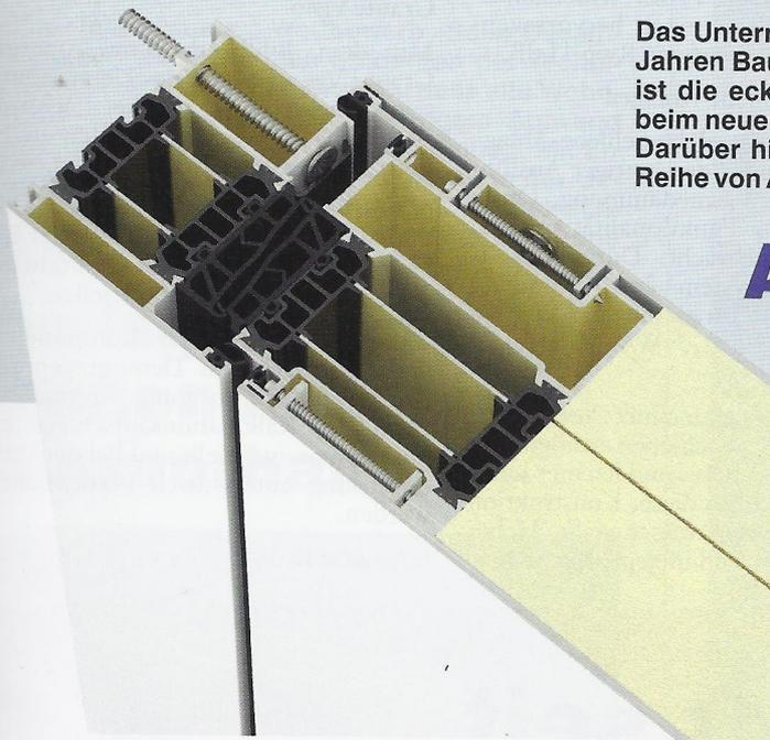
*Haustürsystem Graute-Therm-105. Eine Flügelbautiefe von 105 mm und eine Rahmenbautiefe von 90 mm sorgen in Verbindung mit besonders starken Profilwandungen für eine ausgezeichnete Stabilität.*
